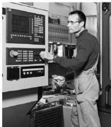
Bild 5: An diesem den Vorschriften entsprechenden Bearbeitungszentrum darf nur im Normalbetrieb allein gearbeitet werden. Für die Behebung von Störungen, für den Werkzeugwechsel und für Instandhaltungsarbeiten muss eine Sicht- und Rufverbindung zu einer zweiten Person bestehen.
