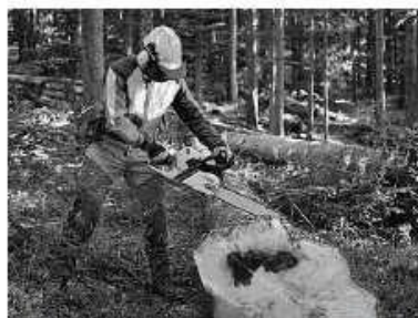
Bild 2: Arbeiten mit der Motorsäge gelten als gefährlich. Es muss eine zweite Person anwesend sein, die bei einem Unfall Hilfe leisten kann (Richtlinie 2134.d).
